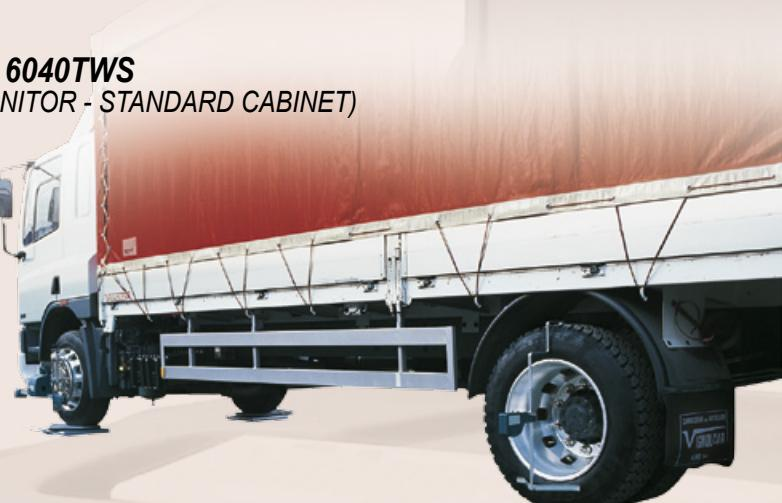
Tramite due rilevatori anteriori con 4 sensori CCD e due trasmettitori a raggi infrarossi posteriori, permette di effettuare in modo rapido e preciso il controllo di tutti gli angoli caratteristici sull'asse anteriore, e in due operazioni il controllo di tutti gli angoli in un veicolo commerciale a due assi. Grazie alla lunga gittata degli emettitori, ripetendo tale operazione è inoltre possibile la verifica degli angoli in veicoli a più assi o a più assi sterzanti.
